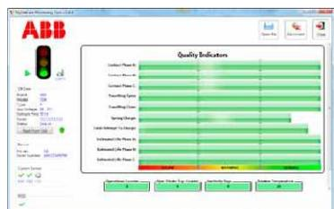
**Si pone l'accento che, poiché MySiteCare è un dispositivo di diagnostica preventiva, la segnalazione "Alert" non indica che si è rilevato un guasto, ma che la qualità di una delle variabili monitorate sta degradando (eventi generati da analisi qualitative) e ha raggiunto il valore di soglia di allerta o che un evento particolare si è manifestato (evento generato da misure puntuali).**
